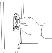
► Débrancher la fiche de raccordement 1 de l'éclairage DEL.
